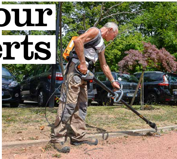
Désherbage des trottoirs avec une binette électrique
