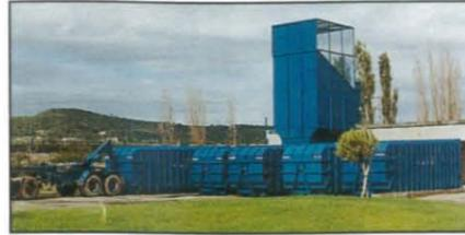
Station avec compacteurs à translation avec approche verrouillage et prise de porte automatique.
