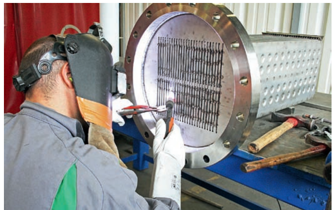
Un échangeur thermique en pleine fabrication.
