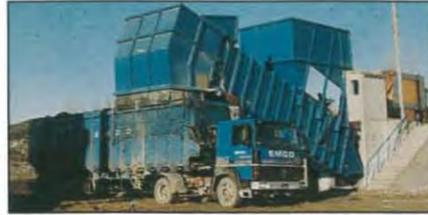
Station avec trémie de stockage 70 m<sup>3</sup> fermée, à bouclier de compression. Transport par semi à bouclier Marrel.
