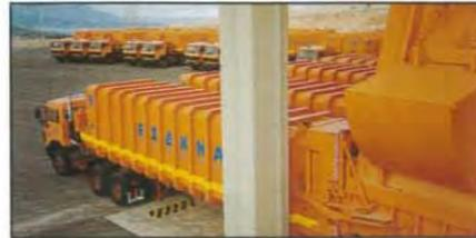
Athènes - Station avec fosses de stockage et compaction en semi remorques à bouclier d'éjection. Capacité : 1.500 tonnes jour. 20 bennes reçues simultanément = 400 tonnes heure en pointe.
